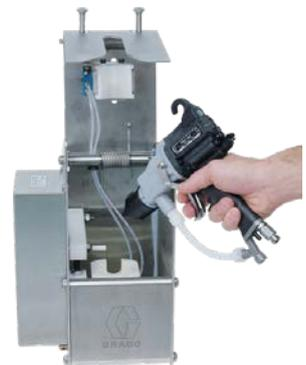
Automatisches Spülen der Spritzpistole mit der genau erforderlichen Menge Lösungsmittel trägt zur Abfallreduzierung bei und senkt die Entsorgungskosten
