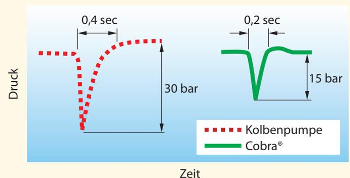
Beispiel: Wasser bei Arbeitsdruck von 150 bar.
