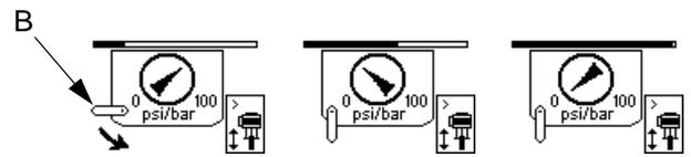
3. Drücken Sie
