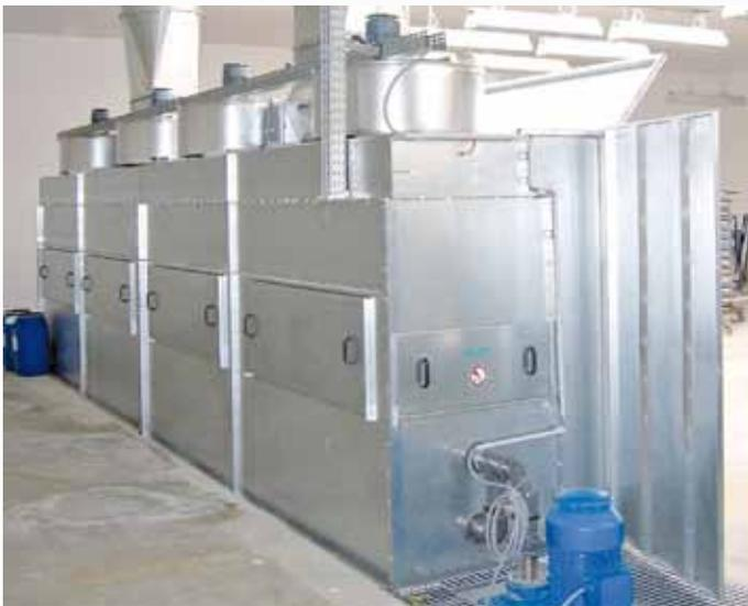
Rückseite mit ausziehbaren Luftfilterkästen
