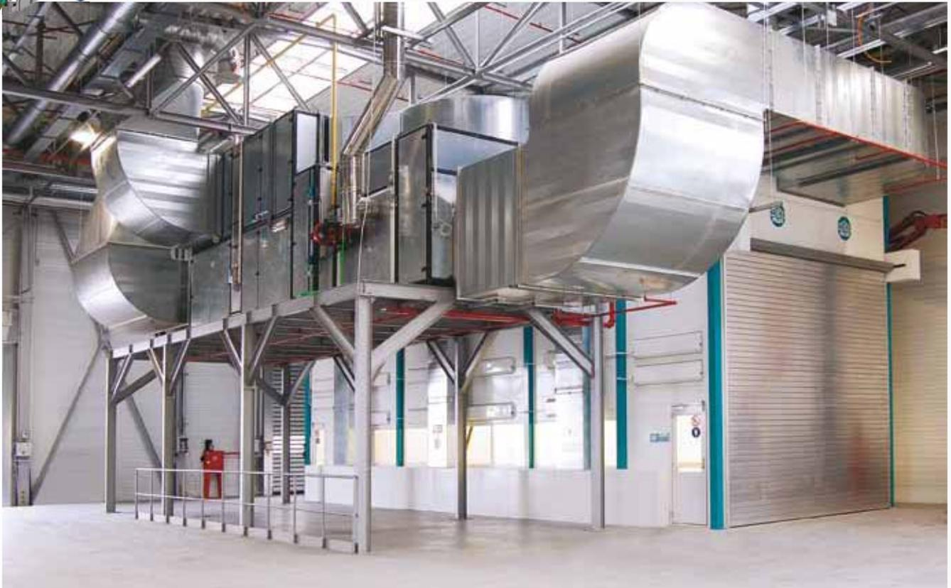
Bei den Abmessungen für Länge, Breite und Höhe existiert eine Staffelung, die es erlaubt, alle Maße beliebig zu kombinieren. Durch die exakte Dimensionierung der Kabine lassen sich alle wichtigen Planungsparameter, z.B. Art der Werkstücke, bauliche Gegebenheiten, Optimierung der Fertigungsabläufe, adäquat berücksichtigen.
