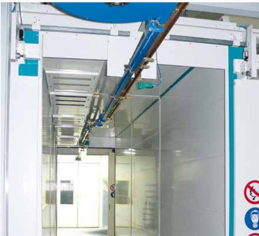
Der Hängeförderer ist im Bereich des Ofens mit einem automatischen Taktförderer ausgestattet, so dass die Trockenzeit variabel einstellbar ist.
