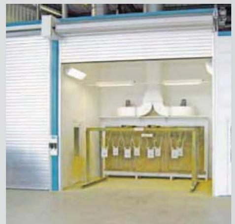
Kabine 2 ist für kleinere Objekte vorgesehen. Die eingebaute Spritzwand kommt mit relativ geringen Luftmengen aus. Das spart Energiekosten.
