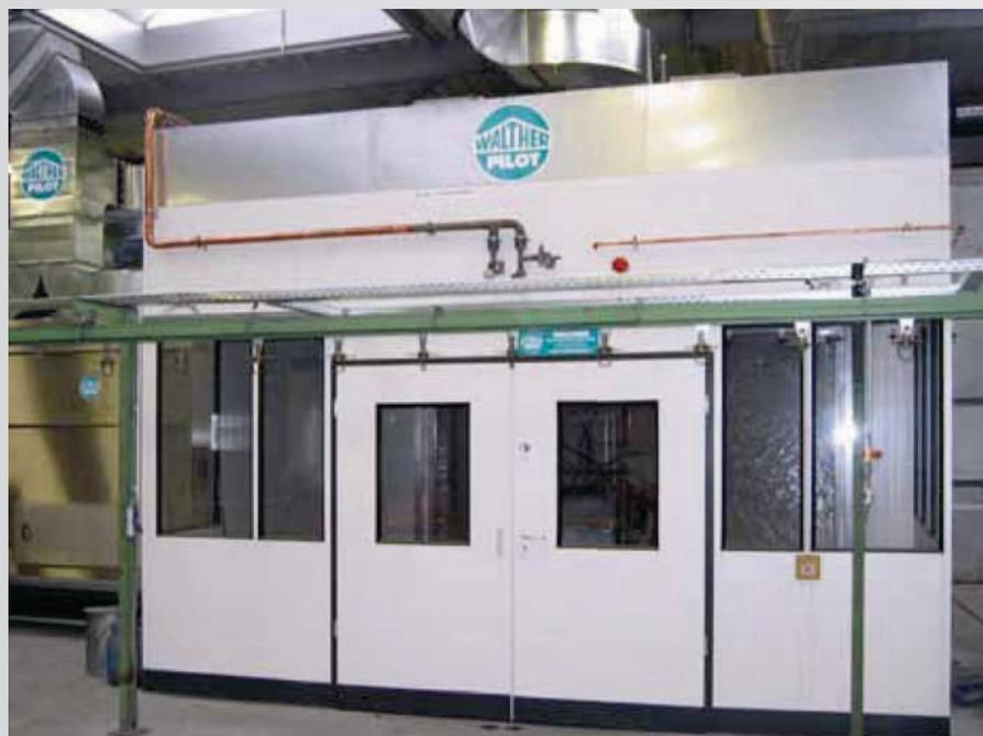
Oben: Eingehauste Spritzkabinen mit Wasserberieselung bei der EOT Eibach Oberflächentechnik GmbH, Lüdenscheid. Für die Lackierung kommen Roboter zum Einsatz. Der dadurch mögliche Umluftbetrieb sichert hohe Einsparungen an Energie.
