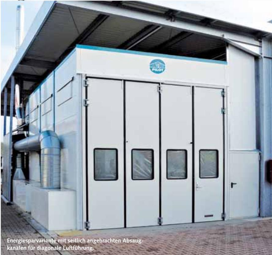
Energiesparvariante mit seitlich angebrachten Absaugkanälen für diagonale Luftführung.
