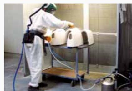
Die Spritzkabine 90 K kann auch mit speziellem Filtersystem für keramische Arbeiten geliefert werden.
