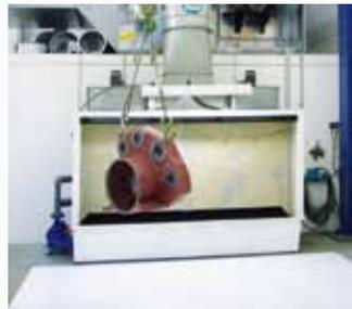
Typ 6022: Die großen Teile werden in diesem Fall mit Hilfe eines Krans zur Lackierkabine bewegt.
