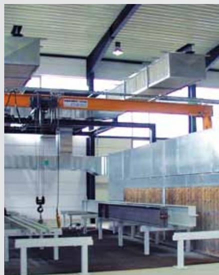
Sonderanlagenbau: Lackierzone für sperrige Objekte mit eingelassenen Spritzwänden. Oben im Bild: Kanäle für die Frischluftzufuhr.
