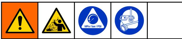
Zur Verringerung der Verletzungsgefahr immer das Verfahren zur Druckentlastung befolgen, bevor ein Teil des Systems überprüft oder gewartet wird und wenn zum Druckentlasten aufgefordert wird.
