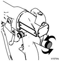
15. Das Drosselventil für die Zerstäuberluft (G) im Uhrzeigersinn ganz öffnen.
